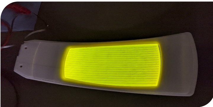
Abbildung 2: Leuchtende OLED in einem Operationslicht-Demonstrator. Die aktive Fläche der OLED ist 206 mm lang und 70 bis 95 mm breit. (Bild mit freundlicher Genehmigung des Fraunhofer FEP)
