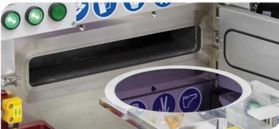
手动装置, 用于装卸载 200 毫米晶圆。 该系统可升级安装 中间机械手、负载锁腔室、 以及进一步的工艺模块。
